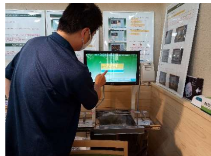
【飯館村道の駅までい館の非破壊式食品放射能測定装置】
